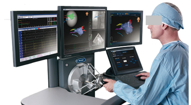
Figura 3 Control del brazo robótico del sistema Sensei ® y extremo distal del catéter Artisan ® Reproducción de Hansen ® Medical.
