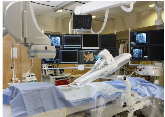
Figura 1 Disposición del sistema de navegación robótica en la sala de Electrofisiología.
