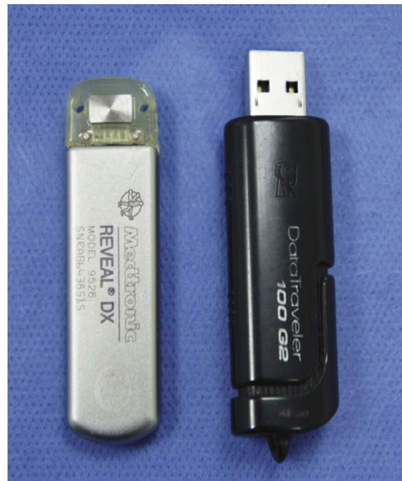
Foto 1 Monitor cardiaco implantable comparado con una memoria USB.
